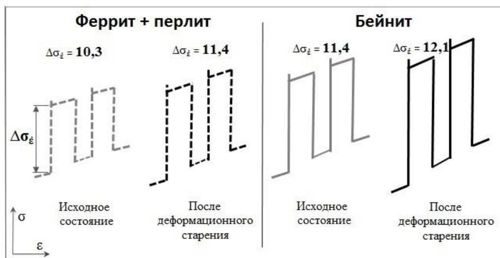
Рисунок 4.25 – Схема изменения прироста сопротивления деформации при переменной скорости нагружения сталей с различной структурой в исходном состоянии и после деформационного старения
