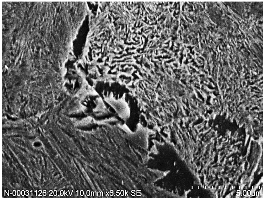
Рисунок 3.30 – остаточный аустенит (черного цвета), мартенсит (игольчатые структуры в левой половине снимка) и мелкопластинчатый перлит (тростит) в правой половине снимка.
