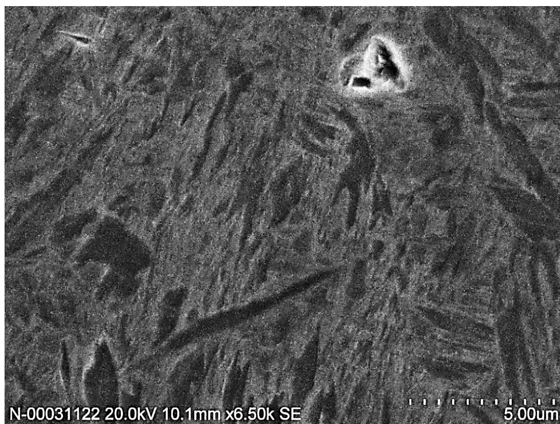
Рисунок 3.27 – Микроструктура образца, термообработанного по режиму №2.
