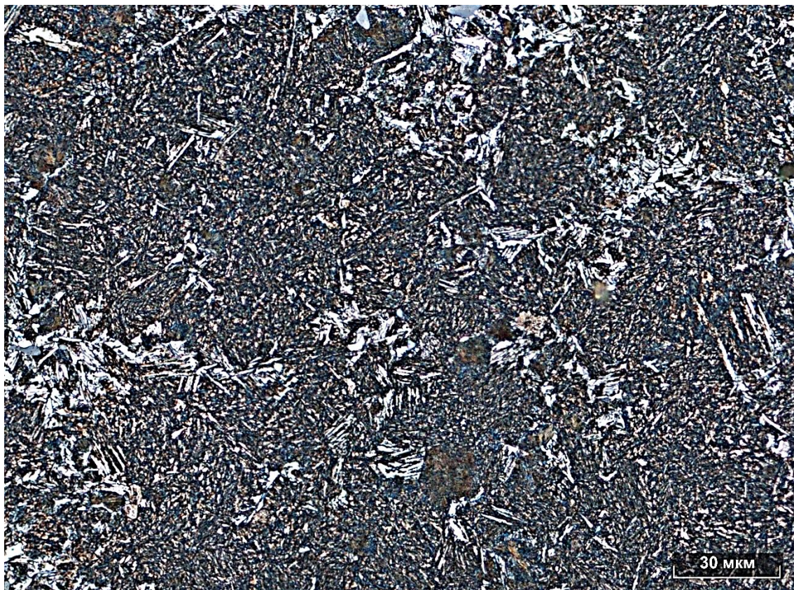
Рисунок 3.34 – Микроструктура образца стали 50 СЛ, термообработанной по режиму №5.
