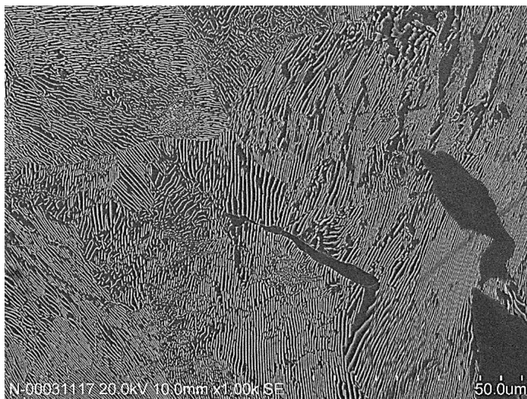
Рисунок 3.23 – Раздробленные цементитные пластины в перлитных зернах
