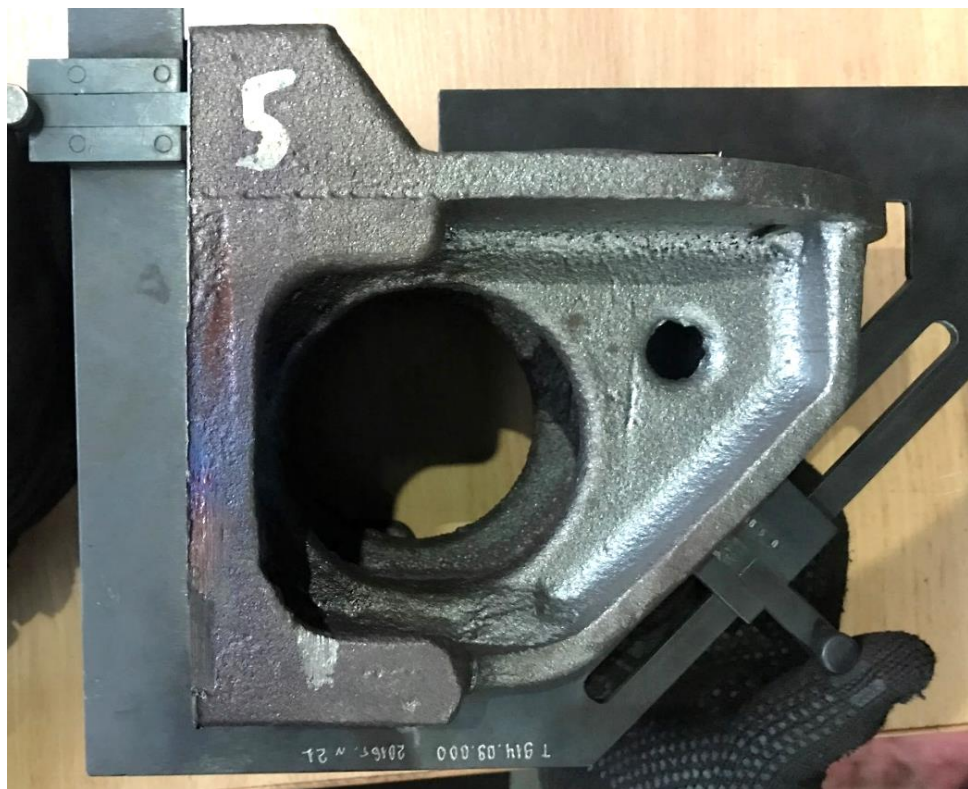
Рисунок 4.8 – Измерение геометрических размеров клина фрикционного после испытаний
