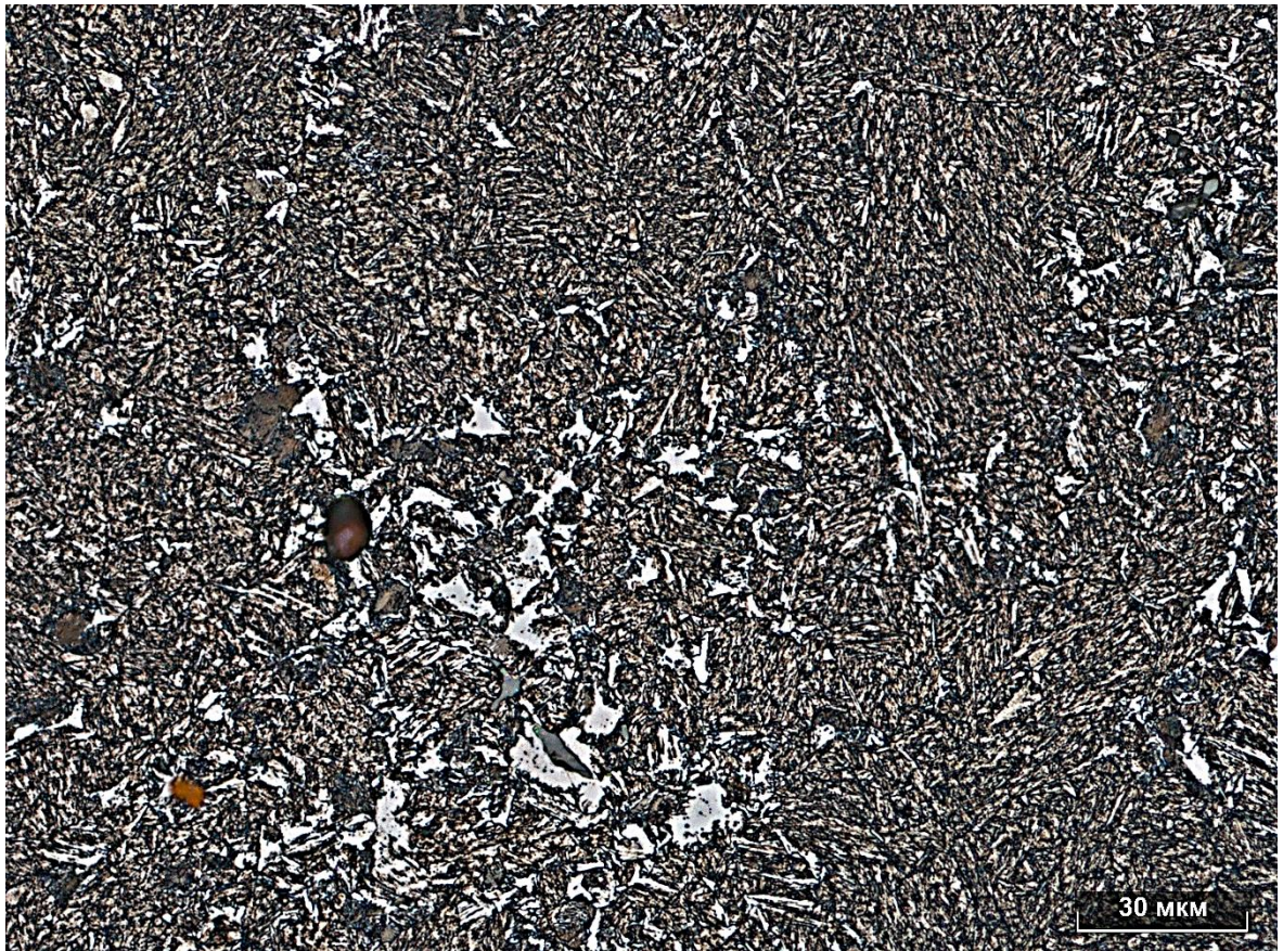
Рисунок 3.42. Микроструктура образца из стали 50 СЛ, термообработанного по режиму №8
