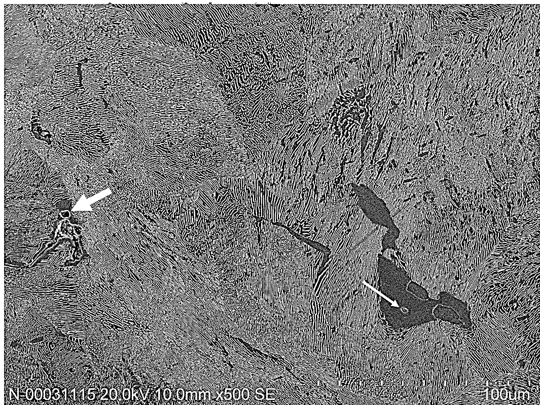
Рисунок 3.22 – Микроструктура отожженной отливки из стали 50СЛ с неметаллическими включениями в феррите, наблюдаемая при помощи РЭМ. Маленькой стрелкой обозначено включение MnS , большой – включение FeO .
