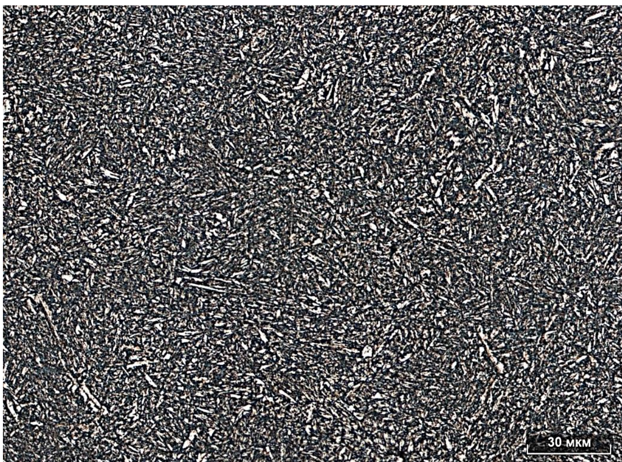
Рисунок 3.39 – Микроструктура образца из стали 50СЛ, термообработанного по режиму №7
