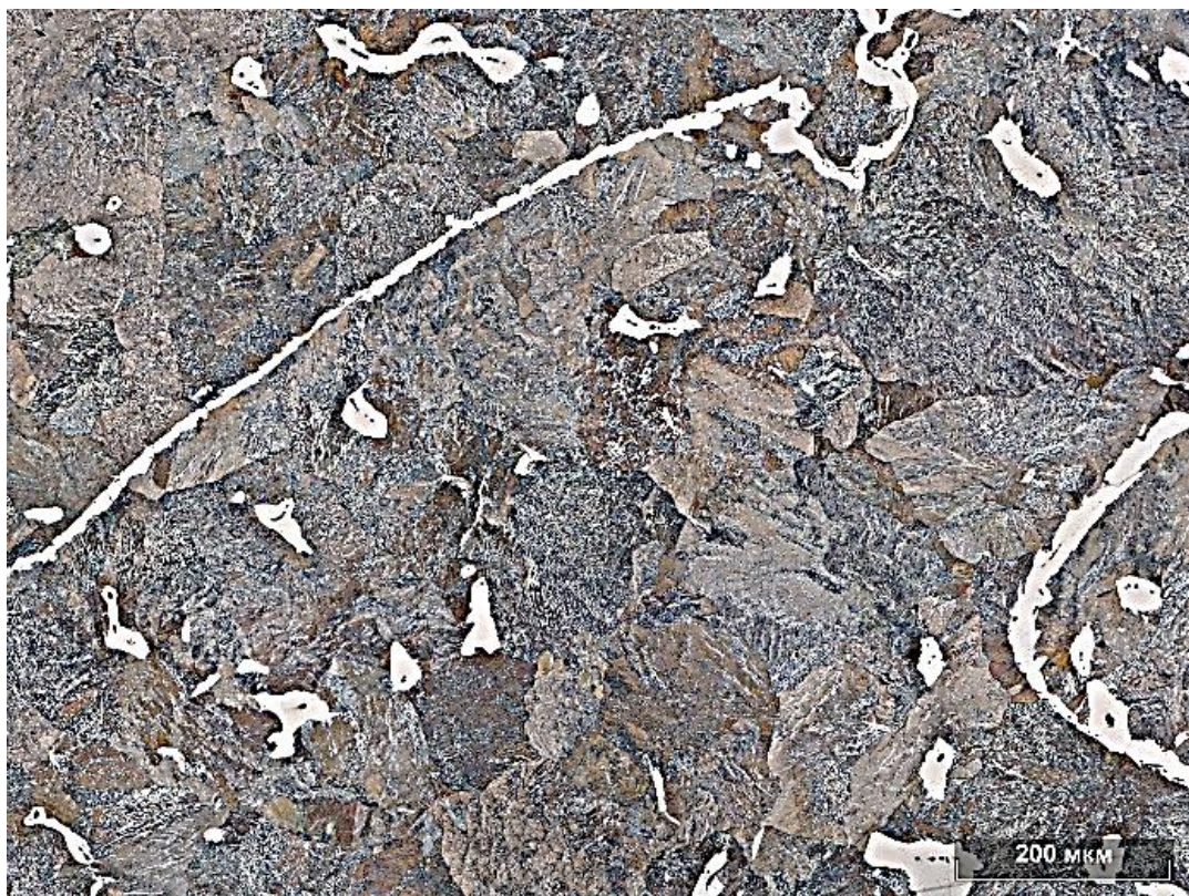
Рисунок 3.20 – Микроструктура отожженной отливки из стали 50СЛ с неметаллическими включениями в феррите
