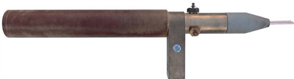
Рисунок 5.3 – Токоподводящий мундштук с керамическим наконечником для сварки под флюсом с большим вылетом электродной проволоки.
