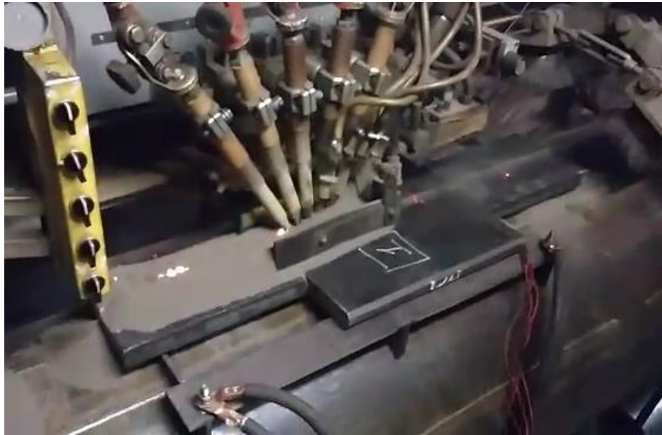
Рисунок 1.8 – Процесс сварки пластины с установленными термопарами.
