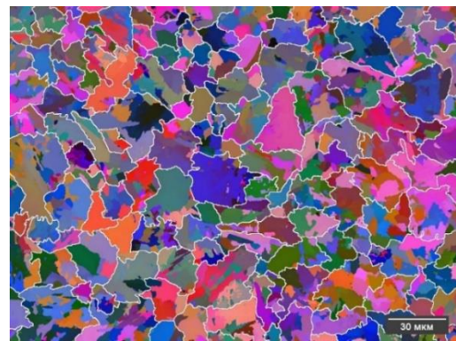
Рисунок 5.20 - Макроструктура (а, б) и ориентационные ДОРЭ-карты (цветом показана разориентировка кристаллитов \alpha -фазы, белые линии – границы бывших аустенитных зерен): в, г – центр шва; д, е – шов; ж, з – ОШЗ; а, в, д, ж – исходное состояние; б, г, е, з – после ТО.
