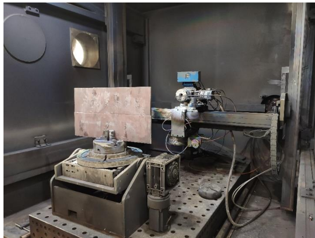
Рисунок 5.14 – Установка пластин под электронно-лучевую сварку внутри вакуумной камеры.
