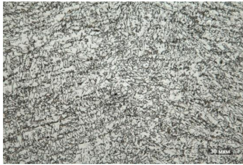
Рисунок 5.16 – Микроструктура гибридного шва с облицовочными дугowymi швами (сталь 06ХГ2НМДБ) (травление в нитале): а) центр лазерного шва; б) зона сплавления гибридного шва; в) гибридный шов в зоне полной перекристаллизации за счет нагрева металла при формировании наружного облицовочного шва.
