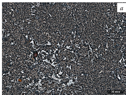
Рисунок 14. Микроструктура образца из стали 50 СЛ, термообработанного по режиму №8: а – метод оптической микроскопии, б – метод РЭМ
