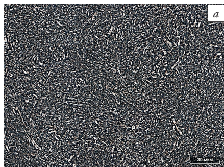
Рисунок 12. Микроструктура образца из стали 50СЛ, термообработанного по режиму №7: а – метод оптической микроскопии, б – метод РЭМ
