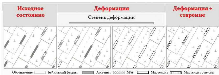
Рисунок 11 – Схема изменения структурного состояния трубной стали в процессе деформационного старения
