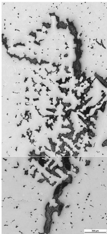
Рисунок 4.13 – Трещина по междендритным порам в осевой зоне НЛЗ
