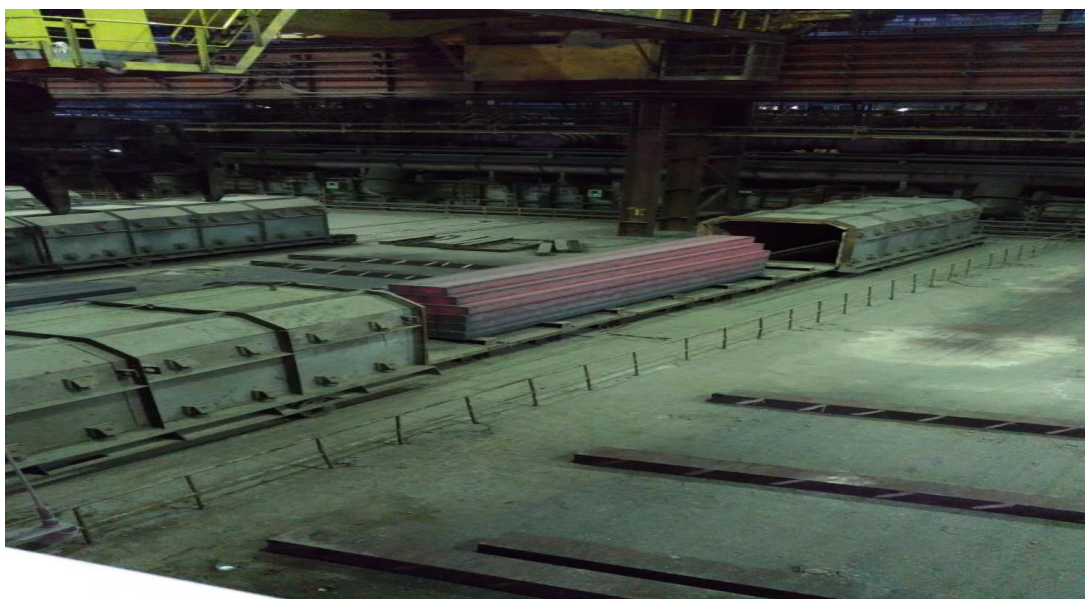
Рисунок 5.2 - Складирование заготовок под колпаки
