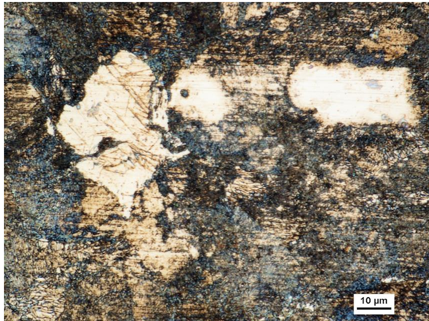
Рисунок 4.22 – Локальное обезуглероживание вблизи дефекта с бейнитно-мартенситной неоднородностью в металле головки рельса
