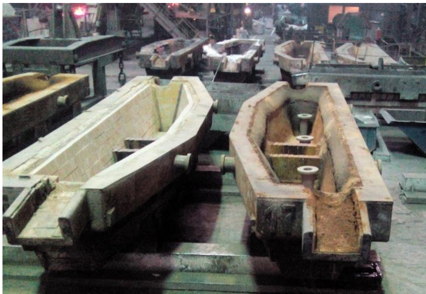
Рисунок 5.1 - Фото футеровки промежуточного ковша
